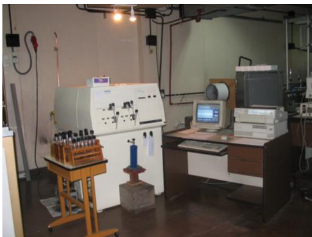
Figura 2: Espectrómetro de masas off-line disponible en el Instituto de Geocronología y Geología Isotópica.
