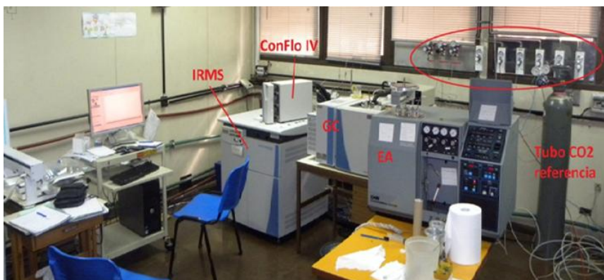
Figura 3: Espectrómetro de masas sistema on-line disponible en el Instituto de Geocronología y Geología Isotópica.
